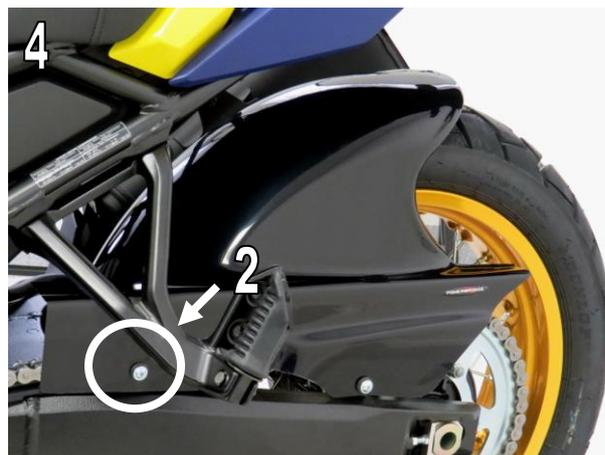
6. Montieren Sie die Abdeckung auf der rechten Seite mit der M6x20-Flanschschaube (2) und befestigen Sie sie durch die Bremsklammern in der Abdeckung, wie in Abb. 5 gezeigt / *Fit hugger on R/H side using M6x20 flange screw (2) and fix through brake clips into hugger as shown in Fig.5*
